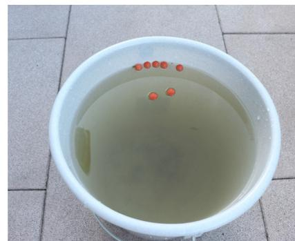
Reinigungswasser nach Schlauchreinigung mit Schwammkugeln
